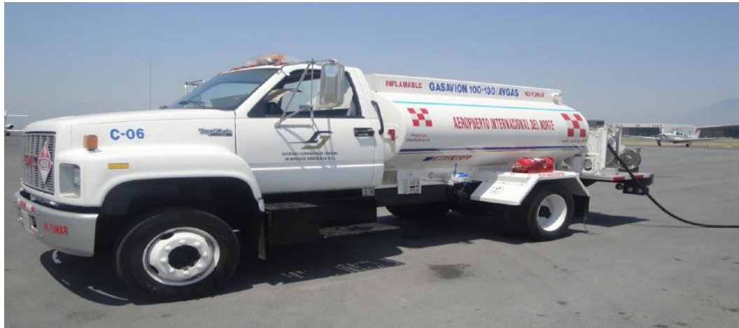
Figura I.5.2.2 Autotanque de gasavión, en acero al carbón de 4,500 L
